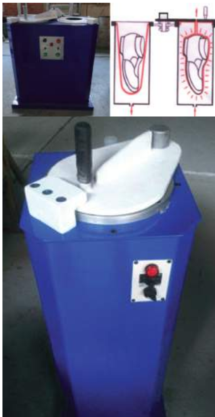
Ilustración ET3: Prototipo plegadora de calzado
