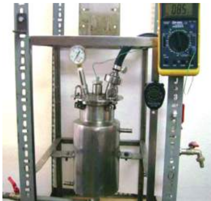
Ilustración ET5: Reactor para pre tratamiento de la materia prima
