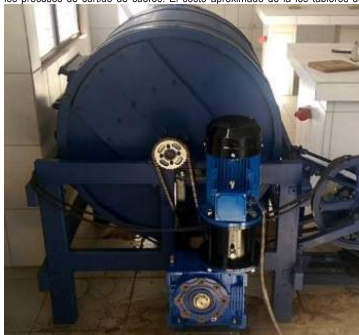
Ilustración ET16: Fulón automatizado | Juan José Edgar Montero Guevara
