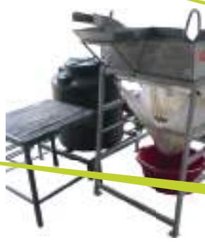
Ilustración ET17: Máquina para obtención de almidón de papa | Mario Huancá
